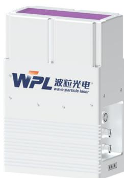
PLV (Power Laser Vision) 模块是一款可以拍摄超高速 (160Km/h) 运动物体的线扫成像一体模块。内含高速线扫相机，成像精度可达每像素0.4mm，拍摄物距从500mm到5000mm甚至更远，通过千兆网与用户PC端相连接，实时传输数据，用户可以通过图像识别技术实现缺陷判定的目的。结构方面采用一体成型外壳，可达到IP67等级防护，同时具备电磁兼容特性，适用于各种复杂、恶劣的工作环境。
