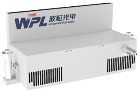
OSI模块是近红外激光光源，匹配高清线扫相机主要用于检测全工艺段的晶硅电池片隐裂、崩边缺角等缺陷。
